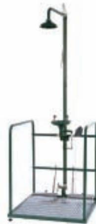
**ISC730** - Combinazione "DILUVIO®" composta da doccia con soffione gigante in polipropilene, valvola a chiusura manuale a mezzo tirante rigido, con impugnatura a triangolo; lavaocchione a flusso aerato con valvola azionata a mezzo pedana e push laterale, bacinella in polipropilene. Completo corrimano perimetrale. Sistema autodrenante, una speciale valvola permette il completo svuotamento dei tubi dopo l'utilizzo, ideale per esterni
