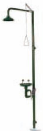
**ISC700** - Doccia "DILUVIO®" combinata con lavaocchione, con soffione in polipropilene completo di valvola a chiusura manuale con azionamento a mezzo tirante rigido con comando a triangolo. Lavaocchione a flusso aerato completo di valvola a chiusura manuale con apertura a mezzo di push laterale e vaschetta in polipropilene. Versione tutta in acciaio inox **ISC700X**
