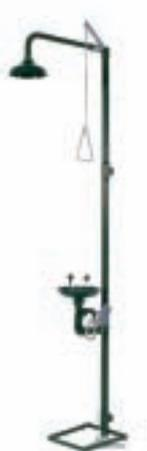
**ISC710** - Doccia "DILUVIO®" combinata con lavaocchione, con soffione in polipropilene completo di valvola a chiusura manuale con azionamento a mezzo tirante rigido con comando a triangolo. Lavaocchione a flusso aerato completo di valvola a chiusura manuale con apertura a mezzo di push laterale, pedale, vaschetta in polipropilene. Versione tutta in acciaio inox **ISC710X**
