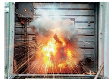
Il cortocircuito genera una corrente di 11 kA diffondendo gas e rame fuso ad alta velocità.
